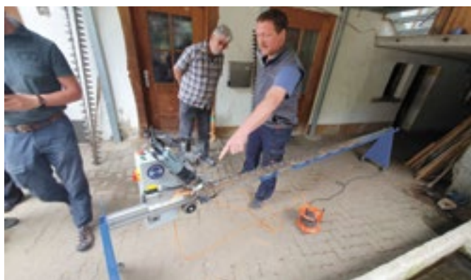
Landwirt Schlachter demonstriert seine halbautomatische Messerbalken-Schleifanlage (Bild: Norbert Höll)
